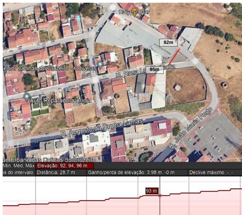
Figura 7 - Perfil longitudinal do terreno
