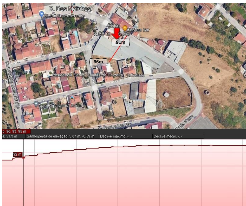
Figura 6 - Perfil transversal do terreno
