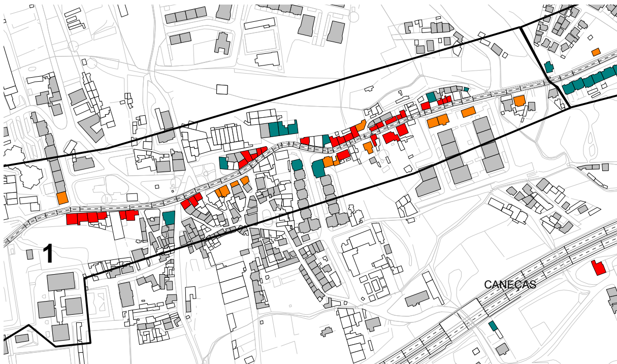
Figura 13. Exposição do edificado ao ruído – Situação existente – Zona 1 (Leste) - UFRC
